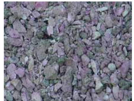
Fig. 2 : Mâchefers d'incinération de co-produits
